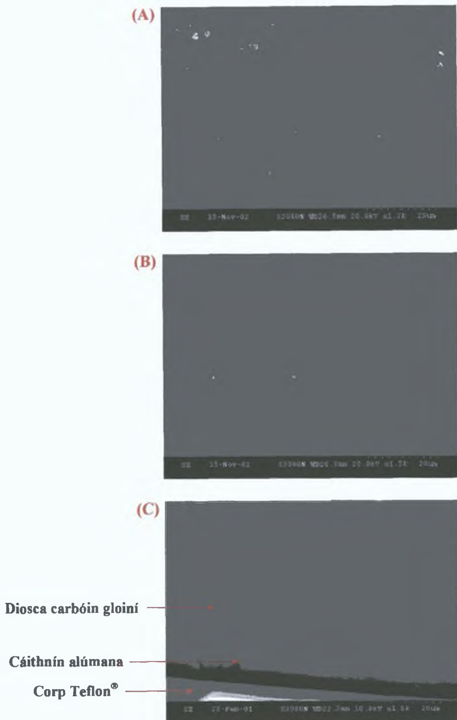
Figiúr 3.26: (A) Íomhá LMS de dhromchla leictreoid LCG a bhí snasta le meascáin d'alúmana i ndiaidh a chéile. (B) An leictreoid chéanna sonactha in uisce déianaithe ar feadh 15 nóiméid. (C) Leictreoid réamhchóireáilte a thaispéanann an comhéadan idir an corp plaisteach Teflon® agus an diosca carbóin (1,200 (A) & 1,500 (B – C) x formhéadaithe, modh brathóra LT).
