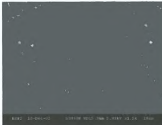
Figiúr 5.7: ar leanúint. (G) 0.157 mg/ml agus (H) 0.078 mg/ml de Ab le collóideacha óra ar leictreoidí clúdaithe le PANI/PVS (1,500 x formheadú).
