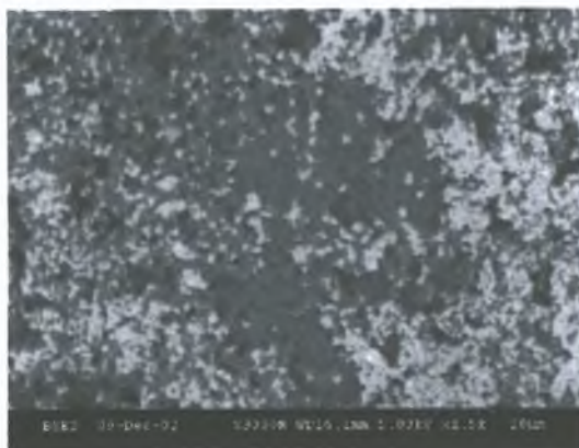
Figióir 5.19: Íomhá LSM de dhromchla mionathruithe le PANI/PVS clúdaithe le 0.625 mg/ml \alpha -GCD- \beta Ab-collóideach óir trí úsáid a bhaint as nós doghluaiste trasnasctha bunaithe ar thúaslagán glútaraildéid (1,500 x formhéadaithe, modh brathóra LCS).
