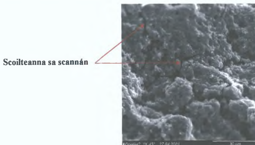
Figiúr 4.14: Íomhá LMS de leictreoid clúdaithe le PANI/PVS a bhaineadh amach trí úsáid a bhaint as 15 ciogail voltmhéadracha (1,500 x formhéadú, modh brathóra LT).
